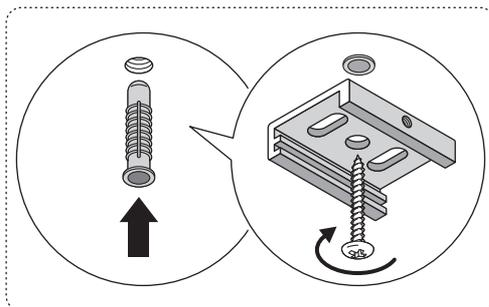
**2** Закрепить на поверхности потолка скобы крепления
